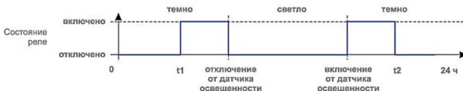
t1 – уставка на включение (включение освещения – утро);
