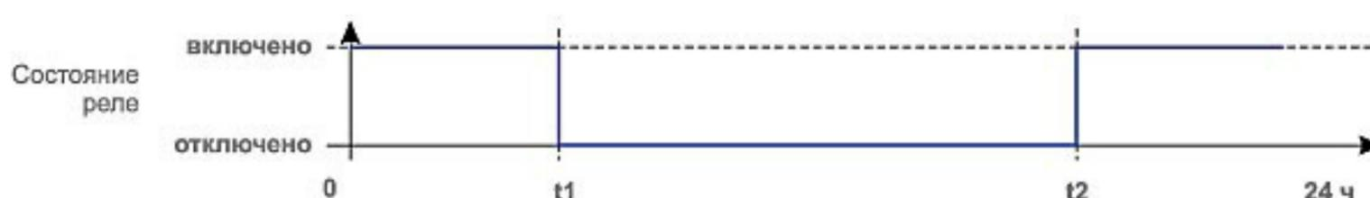
t1 – уставка на включение (выключение освещения – утро);
