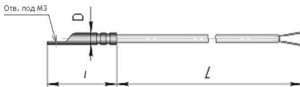
Рисунок 1 – Термопреобразователи сопротивления ТСПг и ТСМг в конструктивном исполнении К5
