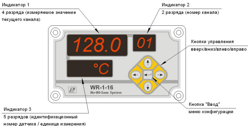
Рисунок 1– Внешний вид лицевой панели и назначение органов управления и индикации измерительного прибора WR–16
